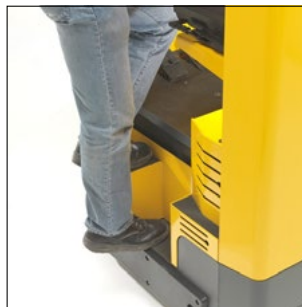
Безопасный вход благодаря низкой подножке
