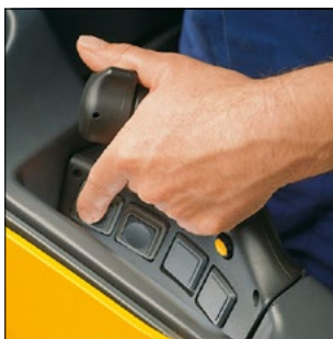
ESE 120: Органы управления скоростью и функцией подъема
