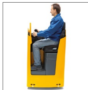
Комфортное размещение оператора с регулировкой по высоте платформы для ног
