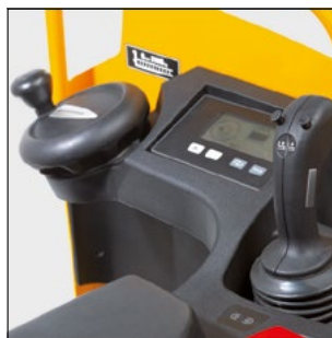
Управление движением и подъемом грузов с помощью многофункционального рычага управления у ESE 220/320
